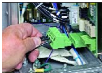
Connettore predisposto per cambio tensione rapido
